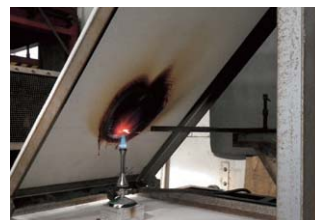
延焼性試験状況
