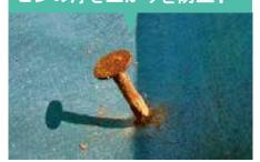
ピンをらせん状にすることで、従来の 垂直に叩き込むものに比べて固定力 が増し、打ち込みが簡単でシートやピ 作業時間を短縮できます。 ンの浮き上がりを防止できます。
