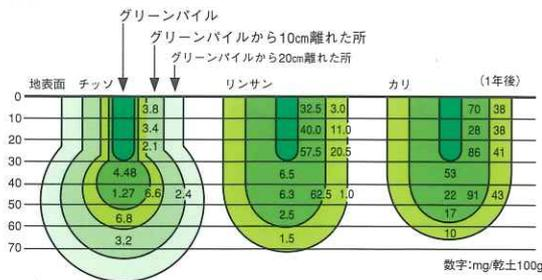
グリーンパイルを土壌に打込むと、左図のように30~60cmの深さに最も多く肥料分が広がり、根の分布に合った溶出をするので、チッソ・リンサン・カリは、いずれも良く吸収されます。(樹木の細根は、新梢の先端の直下の地中で、地表から大体30~50cmくらいの深さの所に最も多く分布しています。) また、肥料分が下層にあるので、根が深層に伸び、旱魃にも風害にも強くなります。
