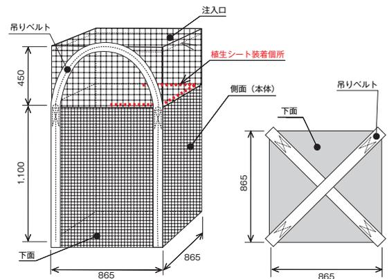
大型土のうは、その優れた施工性から緊急時の災害対策などにおいて、広く用いられるようになってきました。本製品は側面と上面にメッシュ生地を使用し、ここに種子・肥料を装着（植生シート）した新しい大型土のうです。土砂を充填して設置することで、容易に緑化が可能です。災害対策と景観保全の機能を兼ね備えた、これまでにない防災緑化製品です。
